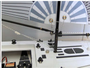
Bild 6 - neuer Mast mit Großbaumbeschlag
