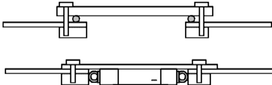
Die obere Skizze ist die Lösung der U-Bootfahrer, die untere mit dem D-Profil ist unsere (Dichtungen grau ausgefüllt).
