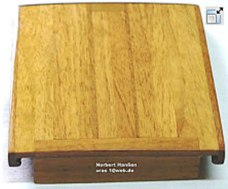
Die Schiebeluke auf der Kajüte besteht aus feinem Nußbaum
