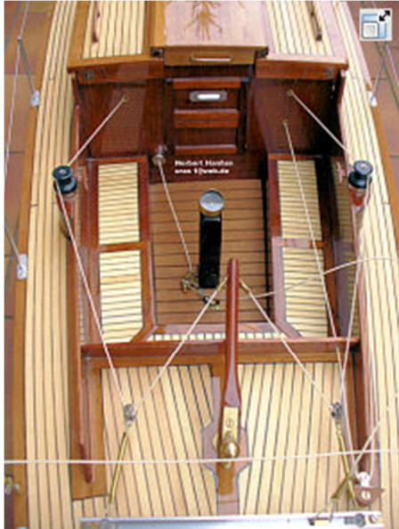
Hier sieht man die Schotführungen und Ruderanlenkung mit dem beleuchteten Kompaß
