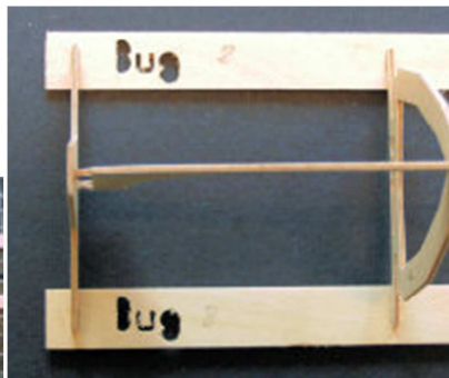
Bild 2b - Die Spanten stecken in den Hilfsbrettchen
