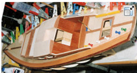
Sperrholzdeck mit angefangener Birnbaum-Beplankung
