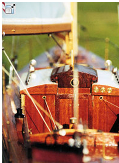
Kajütaufbau von achtern, gut zu sehen die Schotdurchführungen
