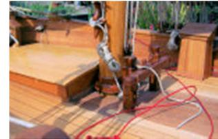
Der Mastköcher ist auch vor der Deckbeplanung einzubauen. Ein zweites Mal würde ich den Mastköcher und die Nagelbank zu einer Baugruppe zusammenfassen und komplett zum Transport demontieren. Es lässt sich dann das viele Tauwerk besser aufschließen, ohne es jedes Mal zu montieren und demontieren.
