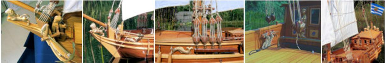
Das gesamte Tauwerk für das stehende und laufende Gut ist in den entsprechenden Stärken auf der eigenen Reeperbahn aus Leinenzwirn selbst geschlagen. Lediglich die holenden Parten für die Segelsteuerung sind aus moderner Kunstfaser.
