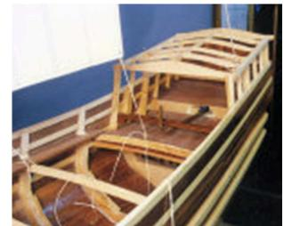
Von den Storck-Linien - 1 : 50 - habe ich mir auf Transparent 1 : 15 Linien fertigen lassen. Auf 10 mm Ahornholz werden die Linien durchgepaust und ausgesägt. Das Holz unten ist waagrecht und die Auflanger sind senkrecht mit einer Lasche verleimt, somit besteht jeder Spant aus drei Teilen und wird mit zwei Laschen verleimt. - siehe oben -
