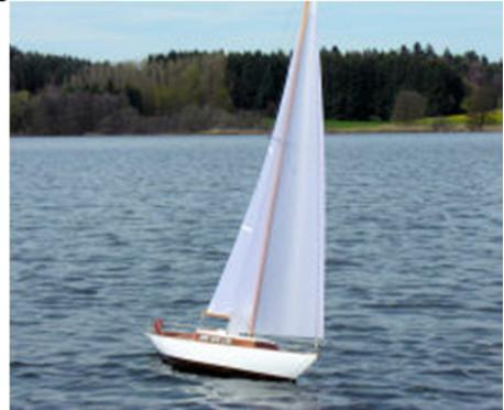
Ein wenig getrübt wurde die Jungfernfahrt durch hakende Vorsegelschoten. Unter Deck funktionierte alles wie geplant. Aber auf Deck verhakten sich die Genuaschoten regelmäßig in den Wantenspannern. Ein kleines Papprollchen um die Wanten gewickelt, brachte hier Abhilfe. Sieht natürlich nicht gut aus, aber funktioniert und wurde deshalb umgehend durch einen PVC Schlauch ersetzt, der ebenso gut funktioniert, aber wesentlich besser aussieht. Die Großen haben das ja schließlich auch.
