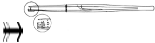
Abb. 3: Die Takelpinzette - eine modifizierte "Pinzette mit Schloß"
