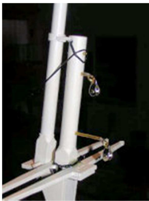
Der Mastkopf des Schonermastes
