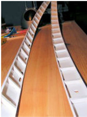
Die eingesetzten Schanzkleidstützen
