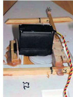
Vorsegelwinde, sie steuert über eine Umlaufschot Klüver und Flieger
