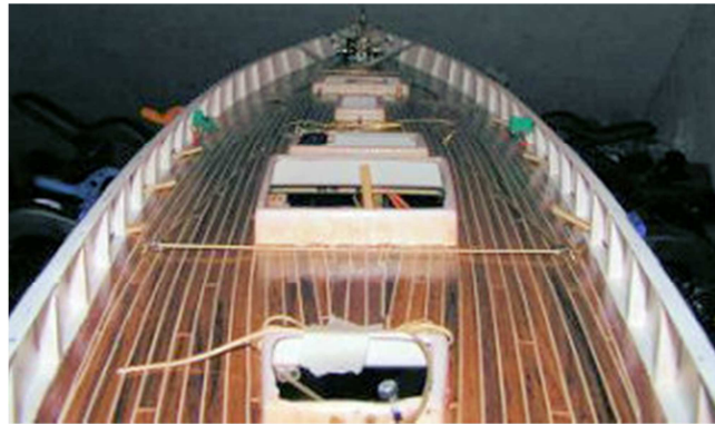
Die aufgesetzten Schanzkleider
