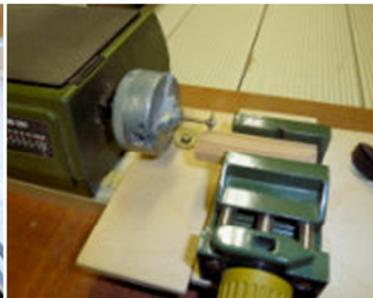
Ablängen der Böcke mit der Mini-Drechselbank
