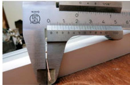
Ein vorher bearbeitetes kurz gespanntes Rundholz von 1mm Durchmesser wird halbrund gedreht und mit der Stahlspitze leicht zentriert. Dann mit einem 0,5mm-Bohrer im Bohrfutter des Eigenbau-Reitstockes die Bohrung eingebracht.
