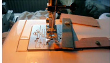
Jetzt wird das bei Rahsegeln auf der Rückseite angebrachte Liektau aufgeklebt. Ein ca. 3cm langes Stück der Segelkante mit Ponal-Express in der Stärke des Liektaus mit einem kleinen Schraubenzieher bestreichen und das Tau in den Leim eindrücken. Schnell ausrichten und mit dem Finger glätten. – Überstand am Segelkopf für Nocklegel beachten!
