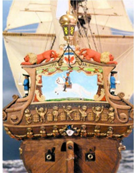
Mit einer kleinen Bohrung im Unterteil wird die fertige Laterne einfach auf die matt schwarz lackierte Halterung aufgesteckt, die aus 3 Stück gebogenen und miteinander verlöteten 0,6mm Kupferdrähten besteht.
