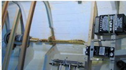
39. Motor mit Schiffswelle
