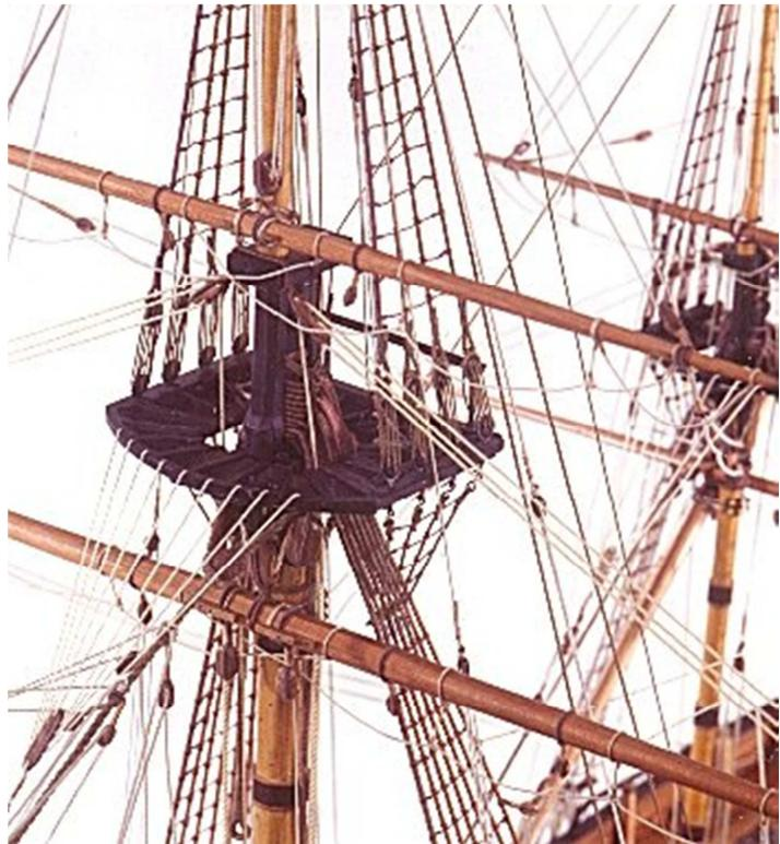
angesprochenen Vorgängen. Ein Großteil aller Takeloperationen dient dazu, alle leichten und schweren Taljen und Takel in eine funktionsfähige Position zu bringen. Bei unseren Modellen wird Funktionsfähigkeit durch eine feste, gute Mittellänge ersetzt, d.h. Rahen und Stengen liegen in einer gewünschten Höhe und Stellung (meist waagrecht).
