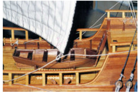
Beiboot in Schalenbauweise
