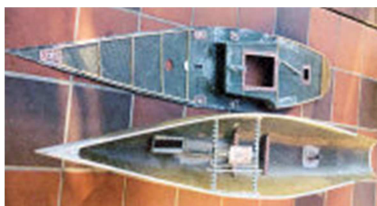
Die vorgefertigten Rumpf- und Deckschalen.
