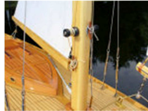
Mastbesläge Die graue "Leine" ist die Empfängerantenne über Deck herausgeführt
