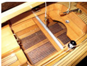
Cockpit mit Travellerschiene, Kompass und Fußboden
