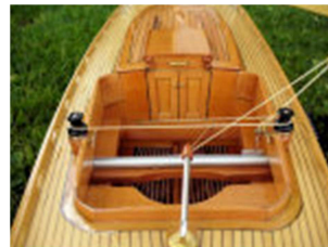
Cockpit mit Travellerschiene
