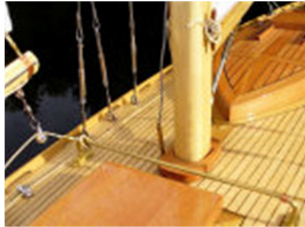
Laufschiene der Selbstwendefock
