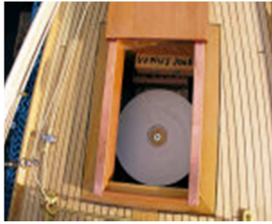
Umlenkung unter der vorderen Decksluke
