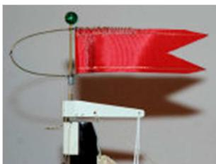
Größerer Verklicker für die immerhin 1,60 m lange Spreizgaffelketch Saturn. Der Stab besteht aus Messingrohr, der in einer Bohrung des drehbaren Masttoppbeschlags steckt. In das Messingrohr wurde eine Leine eingeklebt mit dessen anderem Ende der Verklicker gesichert wurde.
