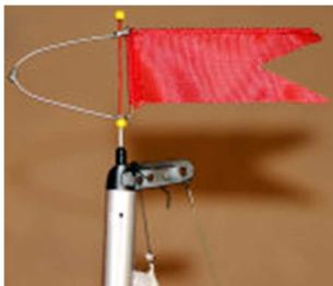
Zierlicher Verklicker einer 1 m Yacht in Standardkonstruktion. Die Lagerung liegt auf einer lackierten, gelben Holzkugel, wie man sie im Bastelladen kaufen kann. Die Hülse darunter sitzt ebenfalls lose drehbar auf dem Stab. Ihr unterer Teil verdeckt außerdem die Sicherung. Es handelt sich um eine kurze Leine, die mit Sekundenkleber am Stab befestigt wurde. Die lose Part ist mit einem Webleinstek am Masttoppbeschlag befestigt.
