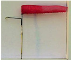
Auch der Flügel dreht sich ausnahmsweise komplett in einer Messinghülse, welche von oben in den Mast gesteckt wird. Ein kleiner, oben angelöteter Haken verhindert, dass die Hülse zu tief abrutscht während unten eine verlötete Hülse wieder das Ausrauschen der Achse verhindert. Das Spannen des Achterstags sorgt wiederum dafür, dass die gesamte Konstruktion im Mast solide fixiert bleibt. Der Flügel dreht sich vor allem auf der Trichterseite der Kabelendhülse.
