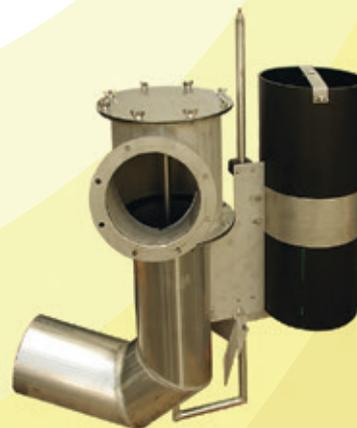
Der selbsttätige Verschluss am Einlauf verhindert den weiteren Zufluss, wenn im Abscheider die maximale Leichtflüssigkeitsmenge erreicht ist.
