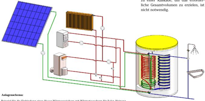
Beispiel für die Einbindung eines Haase-Wärmespeichers mit Wärmetauschern für Solar, Heizung
