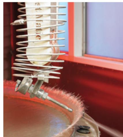
der hauseigenen Wasserstrahl-schneidanlage zugeschnitten. Darauf können Werkstücke bis zum Format 4,50 m x 4,50 m in 3D bearbeitet werden - sie zählt damit zu den größten und modernsten weltweit und kann auch für Lohnarbeiten zum Zuschnitt einer Vielzahl von Produkten bzw. Materialien in Anspruch genommen werden.
