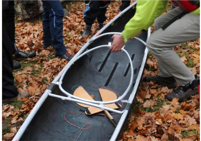
*Auf die Kante der Bootshaut werden eine Versteifung und die Einstiegs Luke einfach aufgesteckt*
