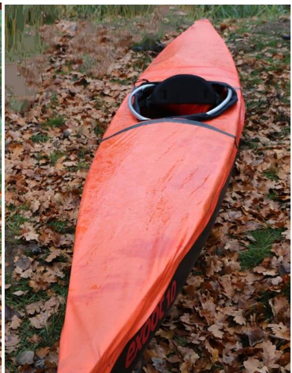
*Zum Schluss wird das Oberdeck aus einer strapazierfähigen und wasserdichten Plane mittels Klettverschlüssen aufgezoogen. Der ganze Aufbau dauert 5 bis maximal 10 Minuten.*
