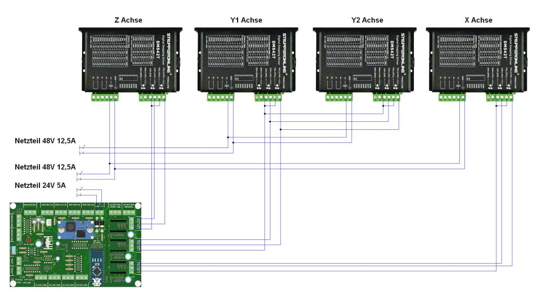
Der GND vom Till Board kommt auf Dir- und Pull - an der Endstufe
