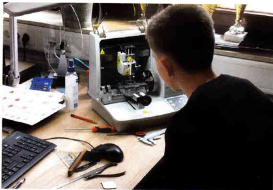
Ein Schüler des Lübbecke Gymnasiums im Rahmen eines Betriebspraktikums bei Gravurarbeiten mit unserem traditionellen "Gravograph-Patographen" (oben) und der "M20-CNC-Graviermaschine".
