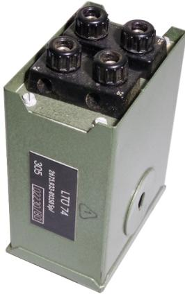
Der Leitungstrennübertrager ähnelt dem Ringübertrager, ihm fehlt jedoch der Mittelabgriff. Somit sind keine Simultanschaltungen möglich. Er kann eingesetzt werden um Leitungen galvanisch zu trennen, Störgeräusche durch Hochspannungsleitungen aus zu koppeln und um Eindrahtleitungen in Zweidrahtleitungen zu überführen.
