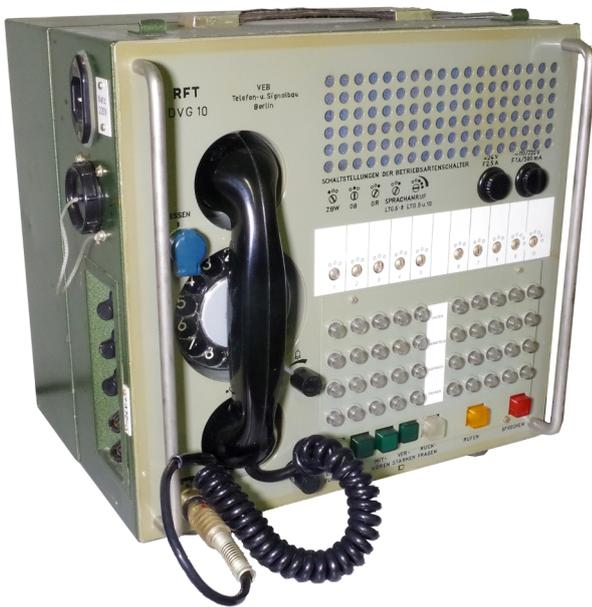
Das DGV 10 gleicht im Aufbau und in der Gehäusegröße dem DGV 5. Es wurde auf der rechten Seite um einen Block mit 5 Anschlüsse erweitert. Wobei auch hier der jeweils erste Anschluss der Blöcke für den Anschluss an ein Funkgerät genutzt werden kann. Sowohl beim DGV 5 wie auch beim DGV 10 waren Konferenzschaltungen möglich.
