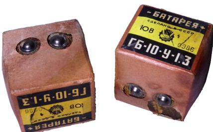
Diese beiden Batterien gehören vermutlich zu den Feldfernsprechern TA -57. Auffällig ist die äußere Umhüllung aus einem glatten Packpapier.
