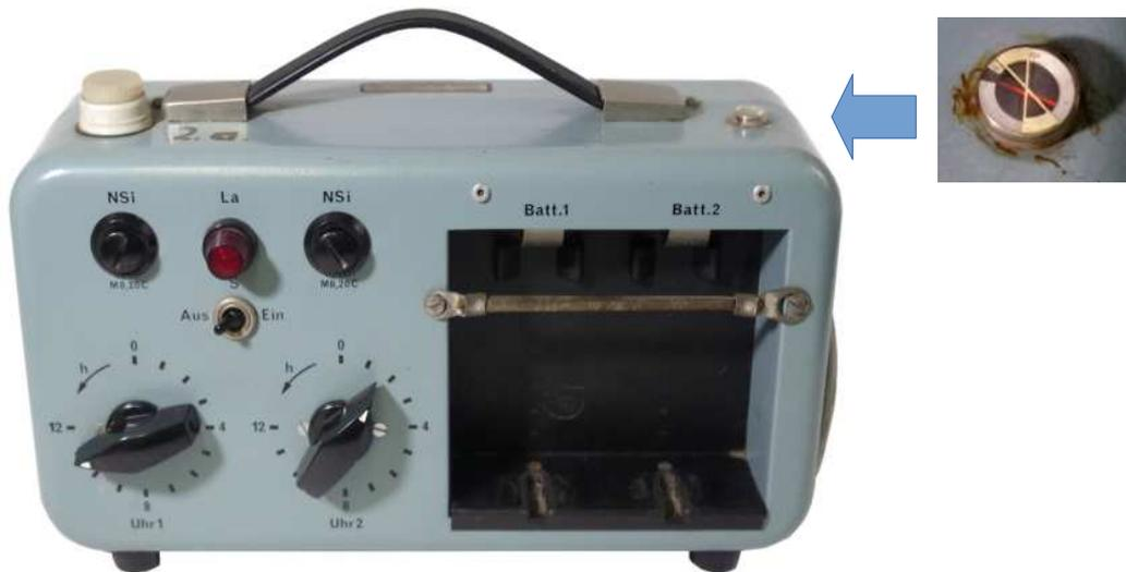
Zur Ladung der Akkus wurde von der Firma Fraco ein Ladegerät angeboten. Mit diesem Gerät konnten zwei Akkus gleichzeitig geladen werden. Dabei war die Ladezeit, mit einer Uhr, für jeden Akku separat einstellbar. Am Ladegerät fand sich oben schon die Spannungsanzeige, die an allen späteren Telefunken- Handfunkgeräten üblich war.
