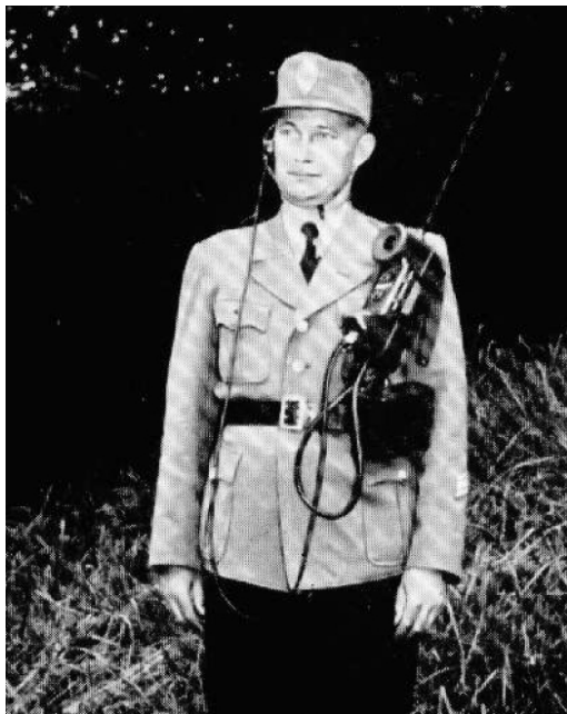
Das FuG 6 und seine Trageweise an der Brust
