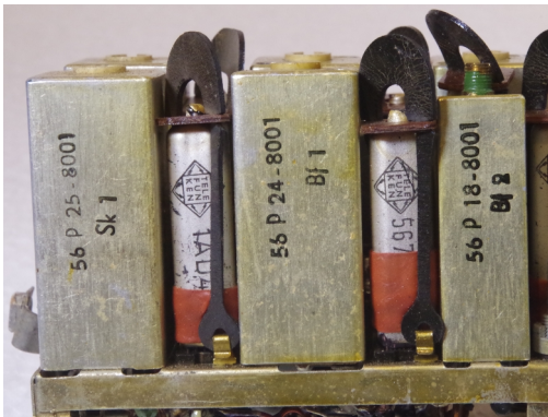
Die beiden Röhrentypen im Gerät eingebaut
