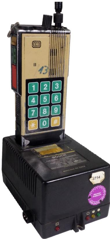
Zu den obigen Geräten wurde noch eine Ladestation angeboten. Diese Ladestationen konnten zusammen gesteckt werden, so das nur ein Anschluss zum 220 V-Netz nötig war. Im Gegensatz zum FuG 10 von Bosch konnte der Akku zur Ladung im Gerät verbleiben. Die Nickel- Cadmium- Akkus konnten eine Kapazität von 450 oder 800 mAh haben.
