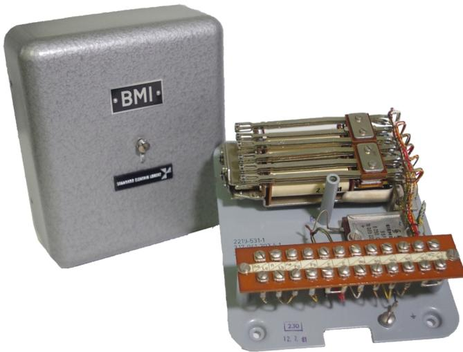
Wie auch bei der Sirene musste gewährleistet sein, dass die Warndurchsage immer Vorrang hatte, wenn ein Fernsprechanschluss mit benutzt wurde. Zu diesem Zweck wurde an der Warnstelle das Warnstellenrelais, auch als Warnweiche bezeichnet, eingebaut.
