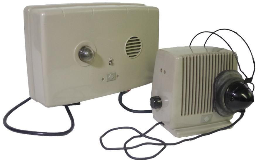
Zusätzlich war der Empfänger mit einem Kopfhörer ausgestattet. Dieser ermöglichte einen Betrieb auch bei defektem Verstärker und Stromausfall. Im zweiten Weltkrieg gab es ein Vorgängersystem, welches als Drahtfunk bezeichnet wurde. Im Verlauf des Krieges hatte man erkannt, dass die Rundfunksender, die für die Durchsage verwendet wurden, den feindlichen Flugzeugen als Orientierungshilfen dienen. Deshalb verlagert man die Durchsagen in das Leitungsnetz der Reichspost.
