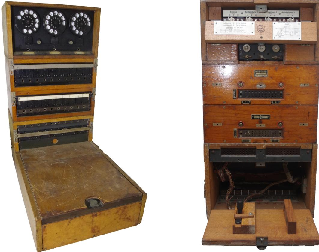
Nachfolger des Feldklappenschranks 16 aus dem Jahr 1916 und Vorläufer der Vermittlung 30/150. Bestehend aus Modulen die leicht transportiert und zusammengebaut werden können. Der Klappenschrank kann durch Zusammenstellen der Module den Bedürfnissen der Fernmeldestelle angepasst werden.
