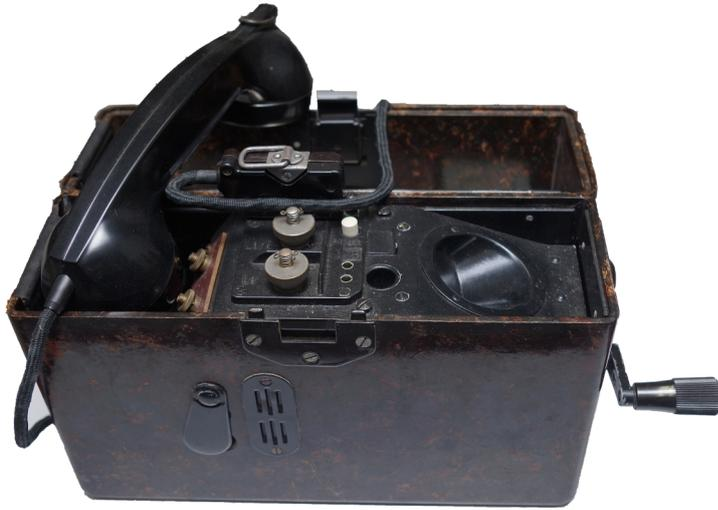
Der Fernsprecher wurde 1934 eingeführt und war der erste Fernsprecher, der kein Holzgehäuse hatte sondern ein Gehäuse aus Bakelit. Bis 1945 wurden etwa 1,6 Mio. FF 33 von verschiedenen Herstellern gebaut. Gegenüber seinen Vorgängern war er robuster, verfügte über eine Dämpfungsschaltung und war leistungsfähiger. Erstmals verfügte er über eine Prüftaste um die Funktionsfähigkeit schnell zu prüfen.
