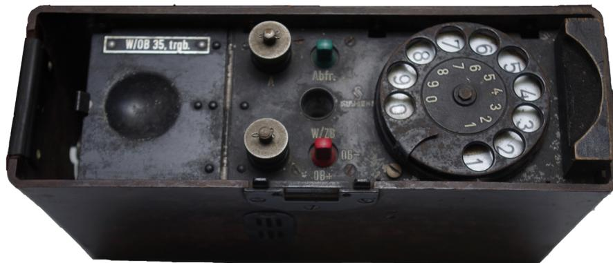
In den 30'iger Jahren forderte das Heeresamt einen Fernsprecher der sowohl im OB- / ZB- und Wählbetrieb genutzt werden konnte. Hierzu wurde der OB 35 weiterentwickelt, der jedoch ein Tischapparat war. Die tragbare Version wurde in das Gehäuse des FF 33 verbaut. Das Exponat wurde von Siemens hergestellt und ist nicht mehr vollständig. Die Recherche zum W/OB 35 tragbar ergab im Internet nur sehr wenige Hinweise, so das davon auszugehen ist, das es nicht sehr weit verbreitet war.
