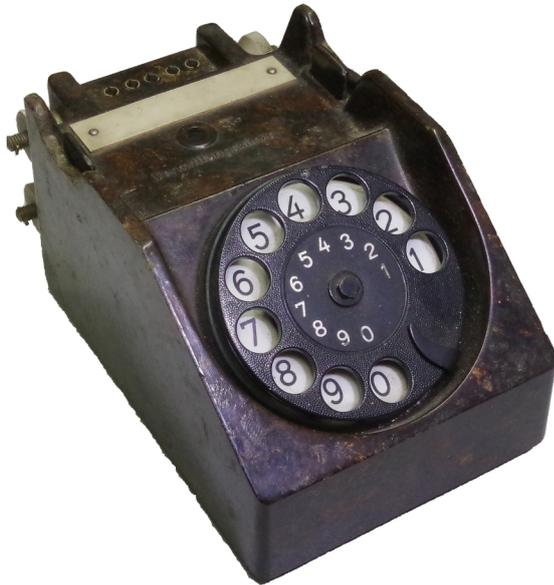
Der Amtsanschießer ist ein vollwertiges Telefon für den Betrieb an einem Wählnetz. Zum Betrieb ist lediglich ein Feldhandapparat nötig. Dieser wurde separat zum Anschließer mitgeführt oder konnte von einem FF 33 genommen werden.
