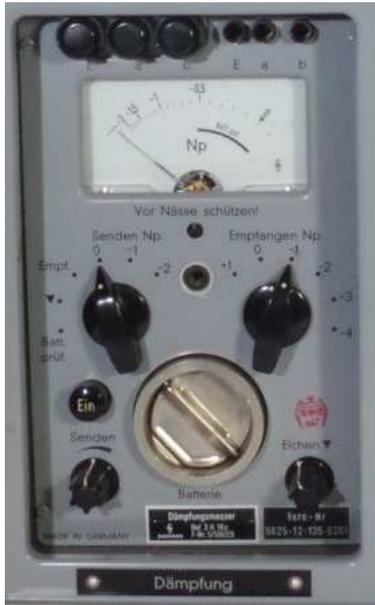
Ein in der deutschen Nachrichtentechnik lange gebräuchliches Maß, es wurde in den 70iger Jahren durch das Dezibel (dB) mehr und mehr abgelöst. 1 Np entspricht in etwa 8,686 dB.
