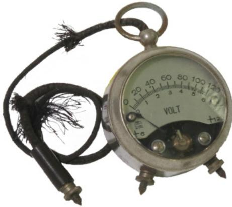
Elementprüfer wurden seit dem ersten Weltkrieg verwendet. Sie dienten zur Überprüfung der Batterien (Als Elemente bezeichnet. Wobei Element eigentlich nur einen Akkumulator, aus einer Zelle bestehend, beschreibt). Der in der Sammlung befindliche Prüfer, verfügt über eine Prüfspitze für 6 V und eine Spitze für 120 V. Der Anschluss für 120 V war zur Prüfung der Anodenspannung an Röhrenfunkgeräten vorgesehen.
