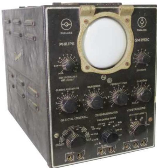
Ab 1937 wurde der Kathograph 3152 von Philips hergestellt und für 965 Reichsmark angeboten, die Version 3152C wurde vermutlich nach 1941 vertrieben. Der Name des Gerätes weist auf den Hauptbestandteil des Gerätes, die Kathodenstrahlröhre, hin. Zu dieser Zeit war die Bildgebung mit einer Röhre eine noch sehr junge Technik: Bei den olympischen Spielen 1936 wurden die ersten Fernsehversuche der Öffentlichkeit vorgestellt. Der Kathograph konnte Frequenzen von 10 Hz bis zu 1 MHz darstellen.
