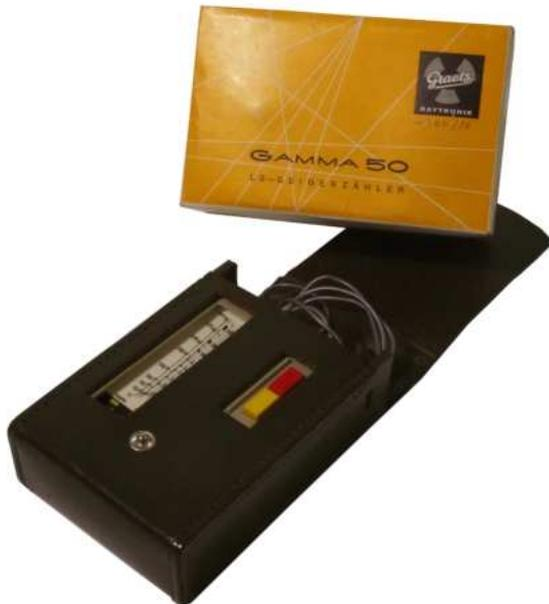
Dieser Geigerzähler der Firma Grätz wurde in der Zeitschrift Ziviler Bevölkerungsschutz im Oktober 1965 beschrieben. Er sollte im betrieblichen Selbstschutz zum Einsatz kommen. Das Gerät verfügt über zwei Messbereiche: 0 - 500 mr/Std. und 0 - 50 r/Std. R steht für Röntgen als Einheit für die Ionendosis. Nach 1978 wurde dann als Einheit im Strahlenschutz das Sievert eingeführt. Mit einem Ohrhörer konnten die Ionisierung in der Zählkammer durch ein Knacken hörbar gemacht werden.
