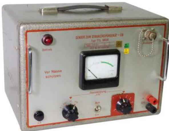
Der zum Spürgerät ÜB gehörende Sender, der über eine Antenne Impulse abgeben konnte. Die Anzahl der Impulse konnte so eingestellt werden, dass eine Dosisleistung von 0,2 bis 200 Röntgen pro Stunde simuliert werden konnte. Das Gerät war über 12 V betreibbar, so das auch ein Einsatz im Gelände möglich war.
