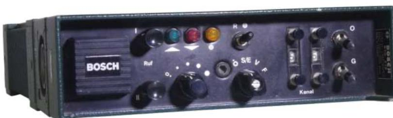
1983 erhielt die Firma Bosch die BOS- Zulassung für ein FuG 9c. Die Gehäuseform hatte sich inzwischen an den „Autoradio-Ausschnitt“ und damit an die Baugröße von Telefunken und SEL angepasst.
