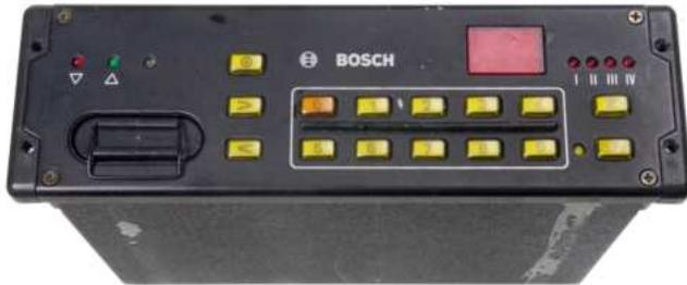
Große Gesprächsanteile im „Tagesgeschäft“ haben immer den gleichen Inhalt, wie zum Beispiel, das Einsatzmittel ist aus zum Einsatz, an der Einsatzstelle eingetroffen usw. Es wurde deshalb nach einer Lösung gesucht, um diese Standard-Meldungen zu automatisieren.
