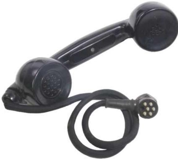
Der Handapparat ist mit einem Anschlussstecker für ein FuG 7 oder ein FuG 2 ausgestattet. In der Beschreibung des FuG 7 wird er als Handapparat schwer bezeichnet. Seine Form wurde für spätere Modelle beibehalten.
