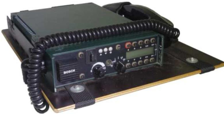
Die Gerätereihe 228, für das 4m Band, und 229, für das 2m Band, stellen den Schlusspunkt der Entwicklung der 8b und 9b-Geräte dar. 1994 erhielt Bosch die BOS- Zulassung für die Geräte, ab 1998 übernahm dann Motorola die Herstellung. Über 20 Jahre bleiben die Anordnung der Bedienelemente und das Bedienkonzept über verschiedene Hersteller und Baureihen gleich.
