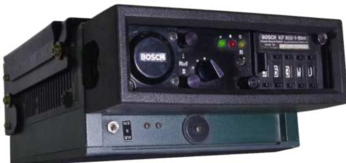
Der Sprachverschiebungszusatz wurde von unten an das Funkgerät angesetzt und technisch in den Sprech-/Hörweg eingeschleift. Zusätzlich konnte der SVZ auch mit einem FMS- Kennungsgeber ausgestattet werden. Mit der Aussendung wurde auch ein Synchronisations-signal versendet. Dabei war es auch möglich, dass Geräte, die später eingeschaltet wurden, das laufende Gespräch mit hören konnten, wenn sie auch über einen SVZ verfügten.
