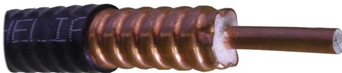
Dem kann durch den Aufbau des Kabels entgegen gewirkt werden. Neben dem Durchmesser des Kabels und der Leiter spielt das Dielektrikum eine entscheidende Rolle: Es füllt den Raum zwischen den beiden „Kondensatorplatten“ Innen- und Außenleiter und wirkt auf die Eigenschaften dieser „Kondensatoren“. Man verwendet hier Polyethylen, je
