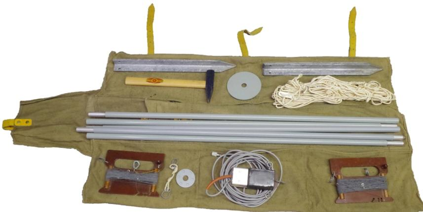
Der Dipol DA 01 ist ein typischer Vertreter einer mobilen Kurzwellenantenne aus dem Bereich der ehm. DDR: In einer Tragetasche konnte der komplette Dipol leicht transportiert und an jedem beliebigen Ort errichtet werden. Aufgebaut wurde er als Invert-V, also als umgekehrtes V. Dieser Aufbau erfordert nur einen Steckmast und verteilte die Sendeleistung gleichmäßiger rund um die Antenne.
