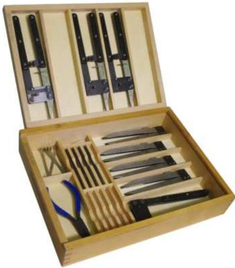
Die Kontakte der Relais und Wähler waren hohen Belastungen bei den Schaltvorgängen ausgesetzt, auch wenn man Schaltungen zur Vermeidung von Funkenbildung (Funkenlöschkreise) einbaute. Weshalb ein Verschleiß der Kontakte unvermeidlich war. Mit dem Kontaktnetzangensatz (KNZ) konnten Kontakte an den Relais und Wählern ersetzt werden.
