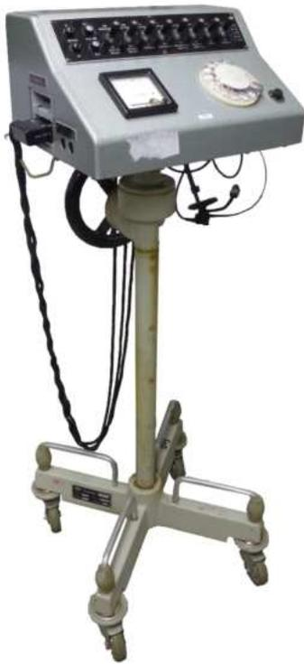
Dieses Prüfgerät befand sich auch am HVT und diente wie der Prüfschrank zum prüfen von Leitungen. Da es fahrbar war, ermöglichte es ein Arbeiten direkt am HVT, was die Suche nach Störungen und das Verfolgen von Verbindungen vereinfachte.
