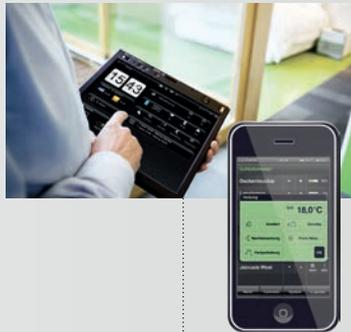
Beim Verlassen des Hauses werden alle Heizkörper auf einen vorher definierten Wert heruntergeregelt. Beim Betreten des Hauses fahren die Heizkörper wieder hoch.
