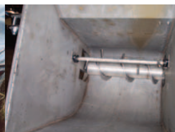
Aangedreven roervijzel voorkomt brugvorming. Le démeleur est entraîné séparément.
