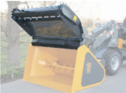
Mobiele uitkuilrees voor het type EV-VB - CCM Fraise de desilage mobile uniquement sur modèles EV-VB - CCM
