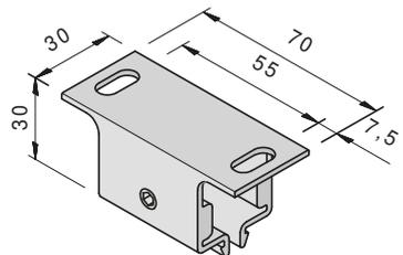
T350 Führungsschienenhalter 30 mm
