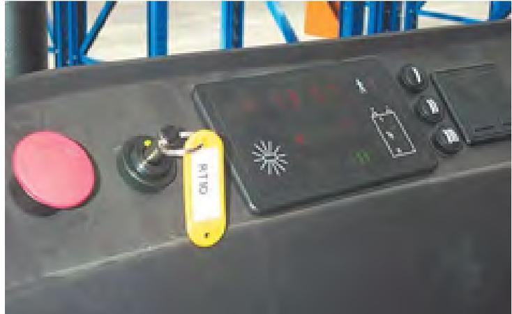
Mit Hilfe der elektronischen Zugriffskontrolle "**Small-Fleet Immobilisator**" von TRAKA gehört der unkontrollierte Einsatz von Staplern, Flurförderzeugen und Maschinen der Vergangenheit an. Der Small-Fleet Immobilisator definiert exakt die Zugriffsberechtigungen der autorisierten Personen und minimiert dadurch das Haftungsrisiko für die Geschäftsleitung.
