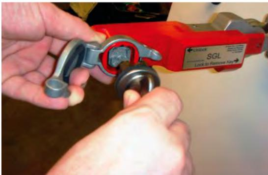
**Schritt 4:** Nach Linksdrehung in die senkrechte Position kann der Salvo-Sicherungsschlüssel entnommen und die Schlossklappe geschlossen werden. Die Salvo-SGL Wegfahrsperrung kann nur mit Hilfe des Salvo-Sicherungsschlüssels wieder von der Druckluft-Bremskupplung entfernt werden.
