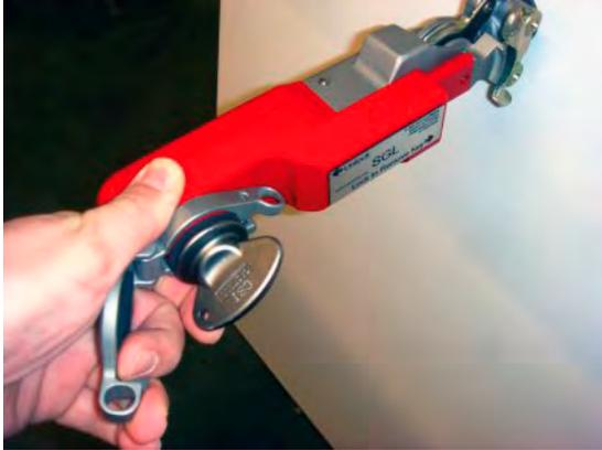
**Schritt 3:** Aufklappen der Schlossabdeckung legt den Salvo-Sicherungsschlüssel frei.
