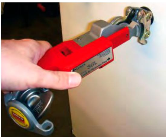
**Schritt 2:** In der waagrechten Position verschließt und verriegelt Salvo-SGL den Druckluftanschluß der Vorratsleitung.
