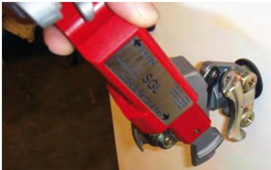
**Schritt 1:** Nachdem der Druckluftschlauch der Vorratsleitung (rot) abgezogen wurde, wird Salvo-SGL auf die SGL-Kupplung der Vorratsleitung (rot) gesteckt und in die Verriegelungsposition heruntergedrückt.
