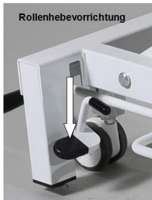
Je nach Ausführung der Liege kann diese mittels Rollen verschoben werden. Zum Verschieben der Liege müssen die Fußhebel des Rollenhubsystems bis zum Anschlag nach unten gedrückt werden. Die Liege steht dann auf Rollen und kann an die gewünschte Stelle bewegt werden. Um die Liege wieder auf die Standfüße abzusenken, den Fußhebel des Rollenhubsystems bis zum Anschlag nach oben drücken.
