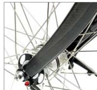
Tragen zum Leichtbau bei: Carbon-Gabel und Sport-Dynamo.
