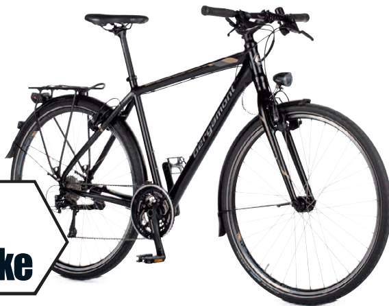
Das Ritzelpaket mit maximal 28 Zähnen arbeitet perfekt in Hamburg. Für Berchtesgaden wäre es unterdimensioniert.
