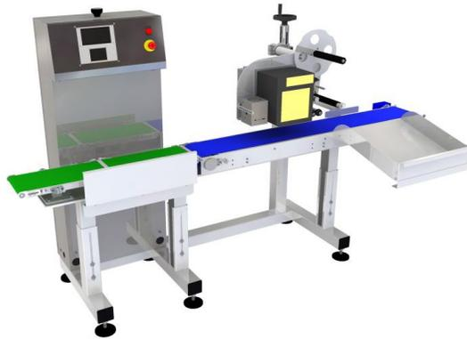
Controlador de peso con módulo etiquetador.
