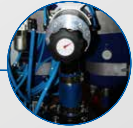
Exakte Dosierung von 100 - 300 ml Material pro Injektion
