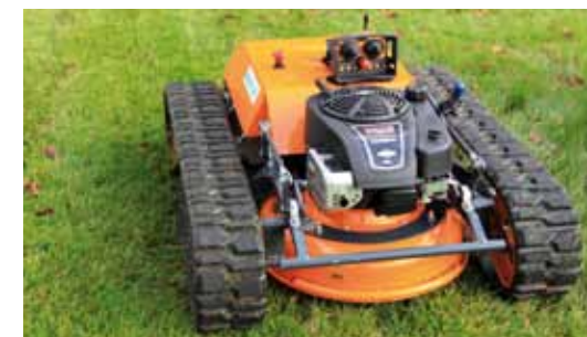
Mulchmähdeck mit hoher Saugwirkung für besten Schnitt auch bei bereits überfahrenem Gras.
