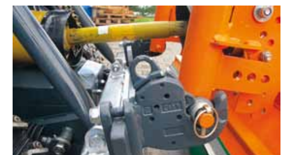
Geräteaufnahme der Kategorie 1 - Standardsystem zum Anbau Ihrer vorhandenen Anbaugeräte.
