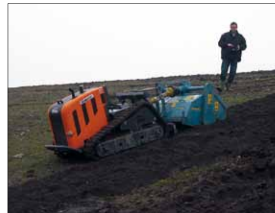
Bodenfräse im Deichbereich
