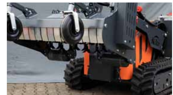
Dank weitem Ausheben ist der Böschungswinkel maximiert; für problemloses Einfahren in den Hang oder in Gräben.
