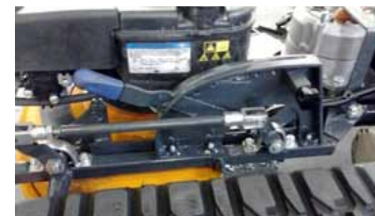
Schnitthöhenverstellung mit integrierter Schwimmstellung und einstellbarer Deckstellung.
