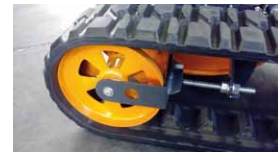
Antriebsräder und Spannräder in Profiausführung mit groß dimensionierten Lagern und Abstreifer.
