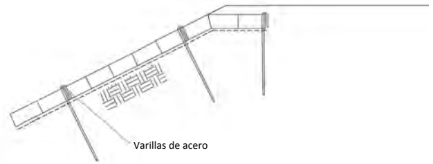
Anclaje con varillas de acero corrugado
