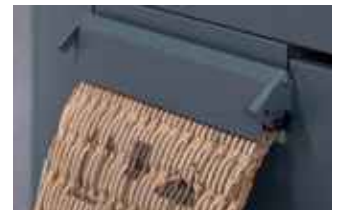
Herstellung von verdichtetem Füllmaterial mit geschlossener Stauchungsklappe (zwei Lagen Karton, HSM ProfiPack P425).
