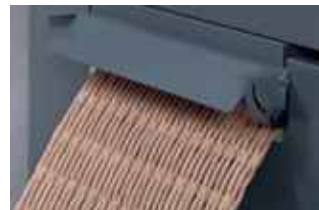
Herstellung von Polstermatten (eine Lage Karton, HSM ProfiPack P425).
