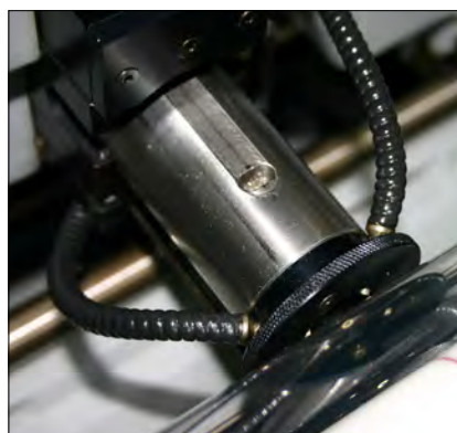
Der Trommelscanner verwendet zur Bilderfassung, den sogenannten Photomultiplier
