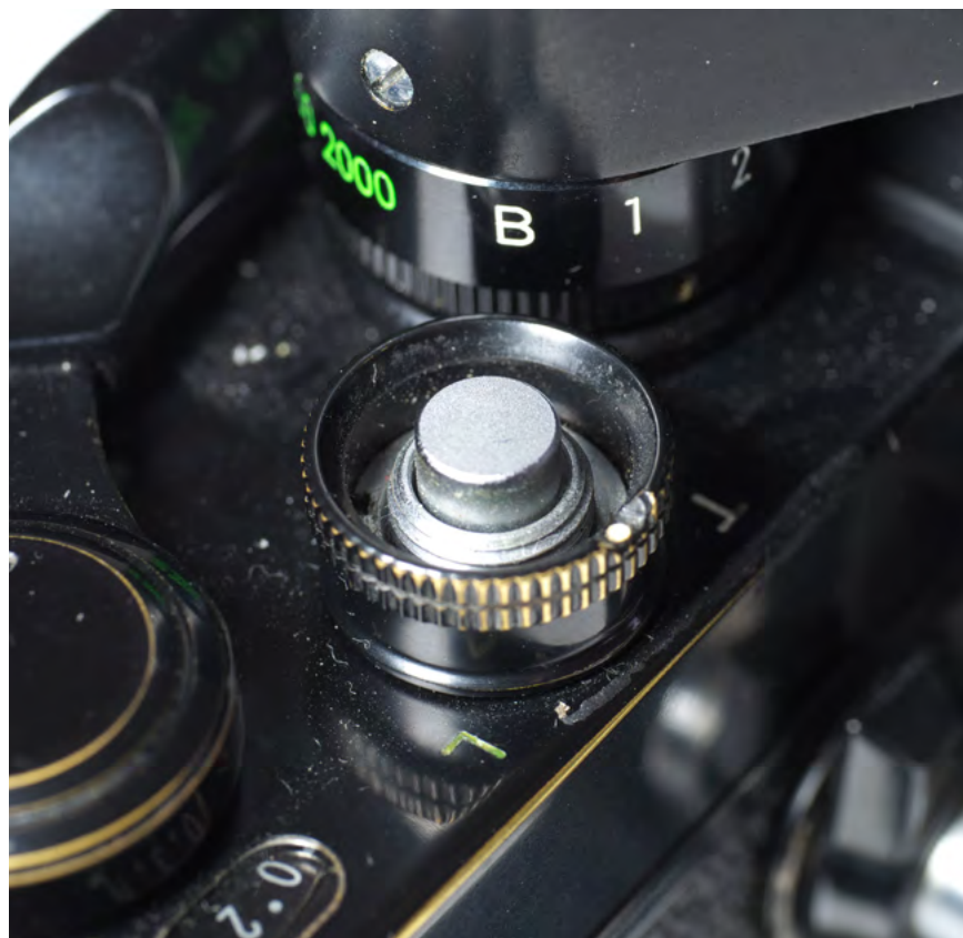
Der Auslöser hat ein Drahtauslösergewinde, lässt sich verriegeln („L“-Stellung) und für Zeitaufnahmen („T“-Stellung) verwenden
