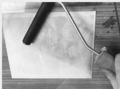
Der erste Farbauftrag erfolgt hier mit einer stoffüberzogenen Rolle.
