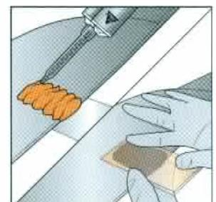
Bei der Nachbildung von Clipsen und Halterungen wird der Klebstoff dank **Sika Kontur-Film** geformt und in Position gehalten.
