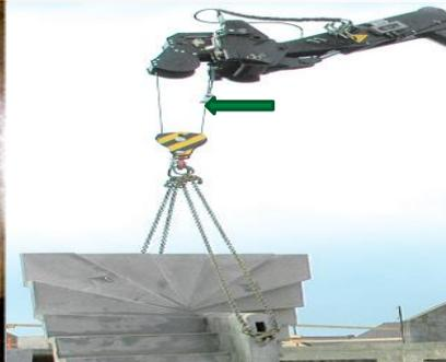
Hubend- und Senkenschalter an Kranwinde des Roto ok?
