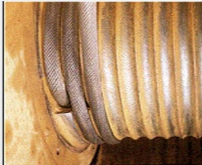
Hubwerkstrommel mit Sicherheitswindungen ok ?
