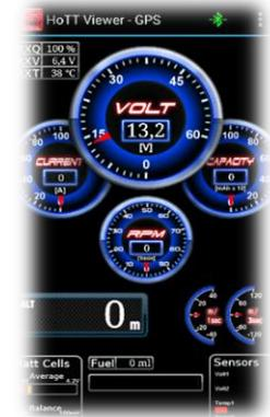
verschiedensten Varianten mit mehr oder weniger Funktionen und natürlich entsprechend variierenden Preisen. Nicht jede davon wird im Schiffsbereich benutzt, daher beziehe ich mich hier auf die von mir verwendeten. Die einfachste Art, ist die der reinen Spannungsüberwachung über das „Voltage Modul 2-4S“. Hier bekommt man die Einzelzellenspannung des angeschlossenen Lipo Akkus angezeigt.
